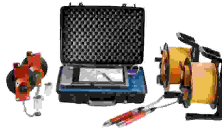
b: Máy siêu âm kiểm tra chất lượng bê tông cọc khoan nhồi
