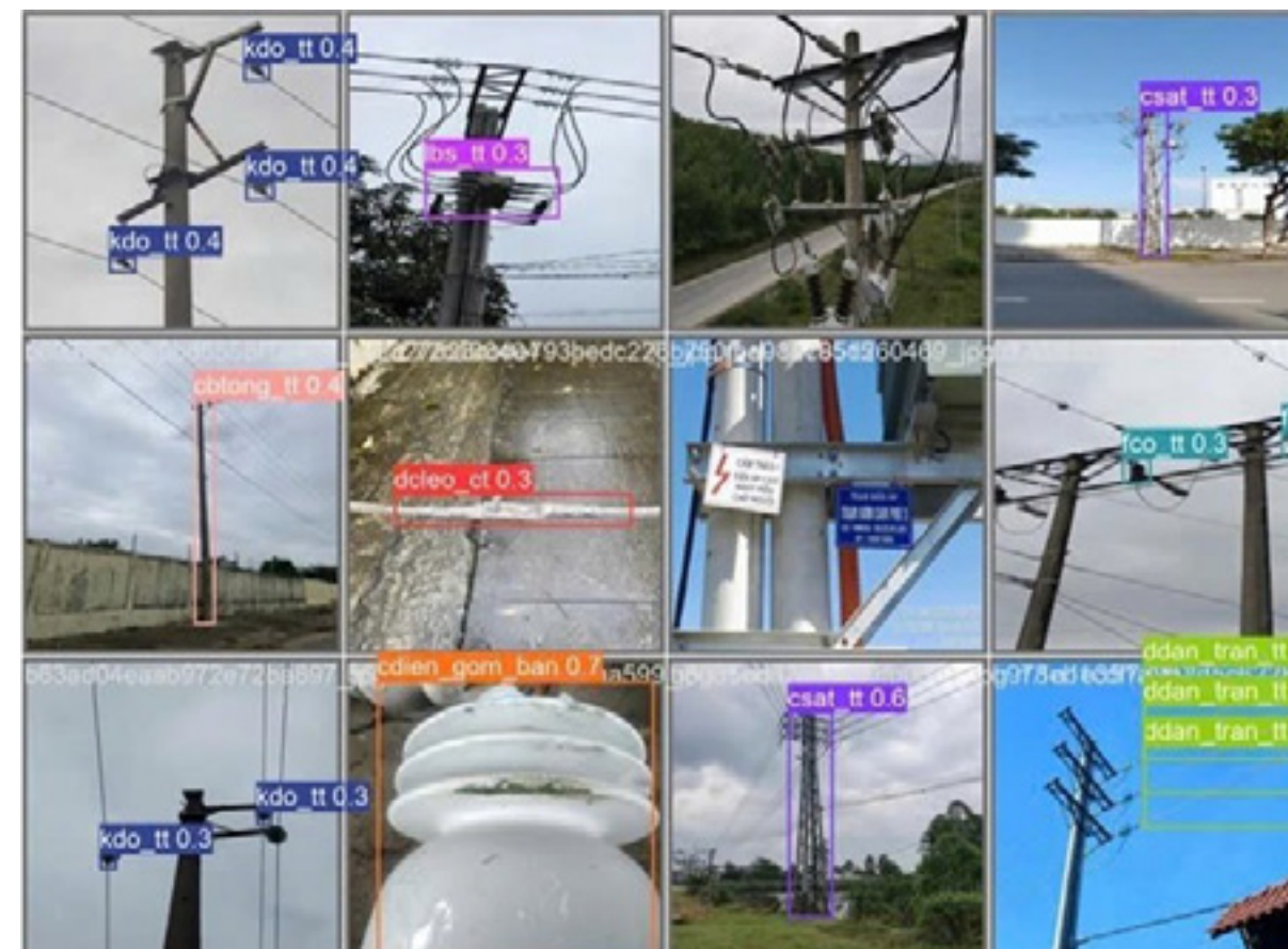
Hình 3: Một số hình ảnh lưới điện được drone/UAV thu thập gắn nhãn và huấn luyện
